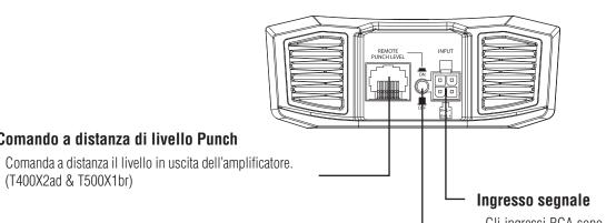
Gli ingressi RCA sono in grado di accettare sia il segnale di livello alto (diffusore) che quello di livello basso (RCA). Quando si usa il livello alto per il segnale in ingresso, la funzione di inserimento automatico è attiva.
