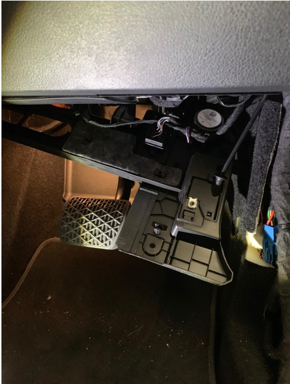
**THE HEAD UNIT IS LOCATED UP IN THE DASH ABOVE THE DRIVERS THROTTLE. DROP THE UNDER DASH PANEL TO GAIN ACCESS**
